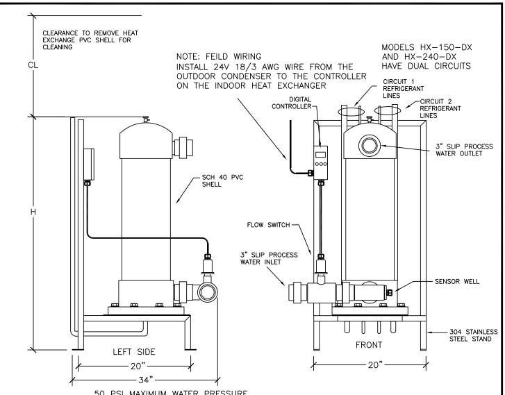
50 PSI MAXIMUM WATER PRESSURE 400 PSI MAXIMUM REFRIGERANT PRESSURE
